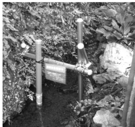
図2. 水圧式自記水位計設置状況
