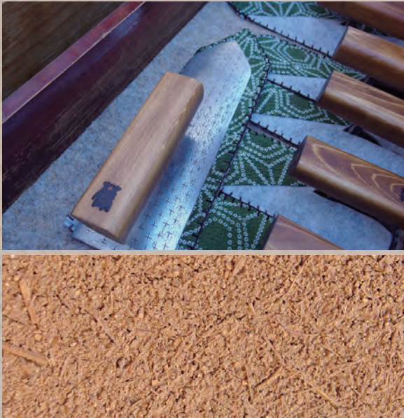
左・右下：藤本さんが手がけた民家の土壁。右写真は土壁を近くで撮影したもので藁や砂のようすがよくわかる 右上：鍛冶屋さんが作ったこて。親指と同じくらい小さなものから手のひら以上の大きなものまで300本以上を使いわける 背景：見せていただいた住宅の壁。「引き摺り」と呼ばれる横に流れるような線の模様が付く漆喰の壁
